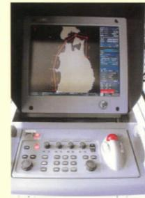
■電子海図表示装置 リアルタイムに自船の位置を電子海図上に表示する装置です。
