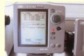
■船舶自動認識装置 AISと呼ばれる国際航海を行う船舶は装置が義務付けられた最新鋭の航海機器で、行き合った船の大きさや動向等の情報が瞬時に分かるものです。
