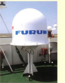
■海事衛星通信装置 衛星回線使用による船舶向けの電信、電話装置です。
