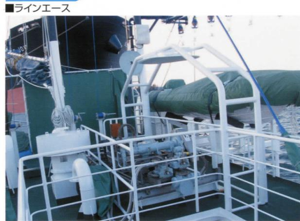
■ラインエース 延縄漁業用の幹縄を巻き取り格納する装置
