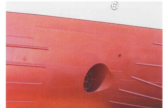
船首を横方向に移動させる装置
